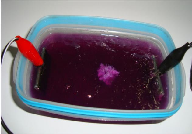
**Figura 01 – Cuba eletroforética feita com caixa plástica e preenchida com gelatina caseira. Foi inoculada uma amostra de leite (centro).**
